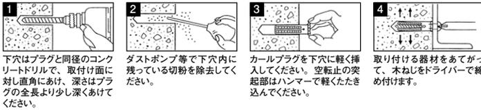
1 下穴はプラグと同径のコンクリートドリルで、取付け面に対し直角に、深さはプラグの全長より少し深くあけてください。
