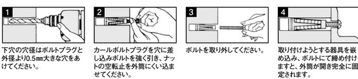
1 下穴の穴径はボルトプラグと外径より0.5mm大きな穴をあけてください。
